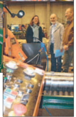
Den seneste investering hos EBI A/S i Skovlunde, en taiwanesisk Cosen N 320-NC leveret af Bornefeldt ApS i Herlev, er sammenbygget med seks meter rullebane på hver side, der sikrer gode muligheder for at sætte savearbejde til henover natten. Fra venstre er det Christina Ibsen fra EBI, Ole B. Holm og Peter Rasmussen, begge Bornefeldt ApS.
