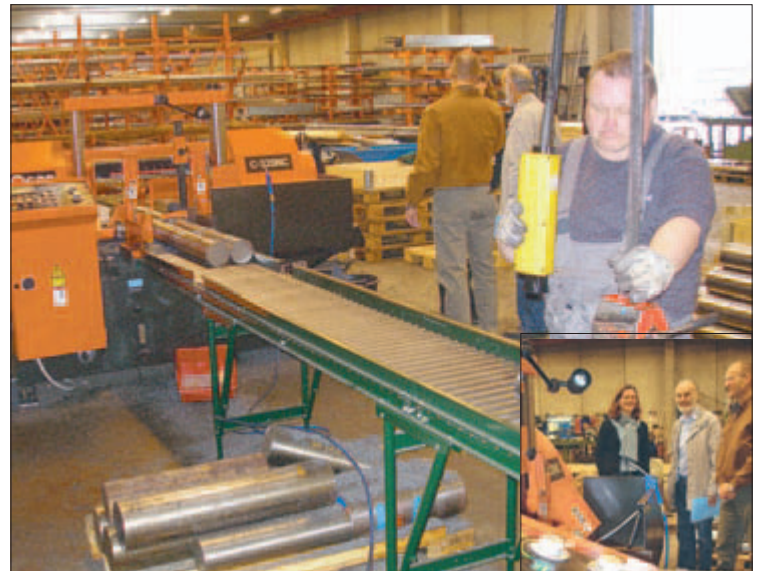
Den seneste investering hos EBI A/S i Skovlunde, en taiwanesisk Cosen N 320-NC leveret af Bornefeldt ApS i Herlev, er sammenbygget med seks meter rullebane på hver side, der sikrer gode muligheder for at sætte savearbejde til henover natten. Fra venstre er det Christina Ibsen fra EBI, Ole B. Holm og Peter Rasmussen, begge Bornefeldt ApS.
